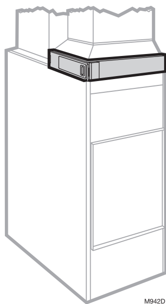
Fig. 4. Appareil de chauffage juxtaposé avec épurateur d'air à fibres monté horizontalement dans le plénum de retour juste au-dessus de l'appareil de chauffage et à l'opposé du plénum de chauffage.
